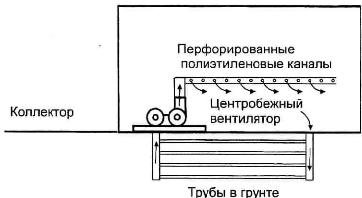
Рис. 2. Система воздушно-солнечного отопления и теплоаккумулирующая система
