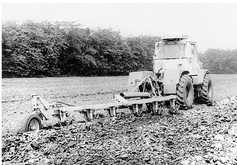
Рис. 2. Плуг ПЛК-6-35 в агрегате с трактором Т-150К. Вид в работе
