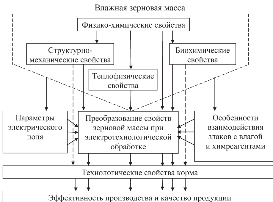
Рис. 2. Схема формирования технологических свойств подготовленной зерновой массы в процессе электротехнологической обработки
