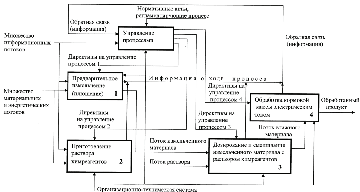
Рис. 3. Контекстная модель технологического процесса обработки злаковых кормов электрическим током
