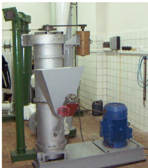
Рис. 1. Установка для тонкого измельчения и классификации
