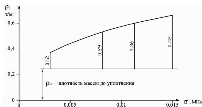
Рис. 2. Изменение плотности массы через 6 сут в результате уплотнения статической нагрузкой различной величины в течение суток
