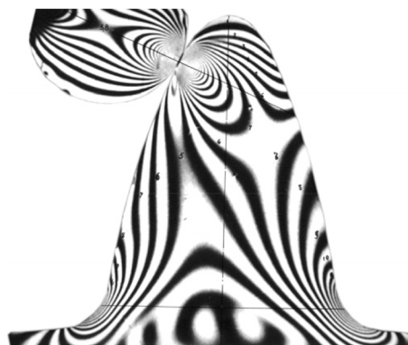
Рис. 2. Интерференционная картина распределения напряжений на модели
