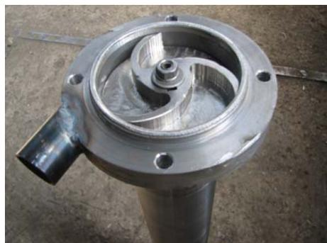
Рис. 2. Насос для перекачки высокотемпературных масел
