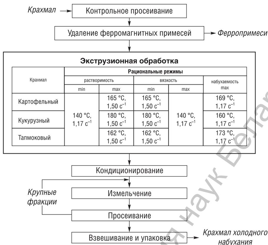
Рис. 7. Усовершенствованная технологическая схема получения набухающих крахмалов экструзией
