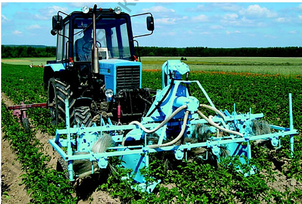
Рис. 10. Комбинированный агрегат для сбора колорадского жука и окучивания картофеля в работе
