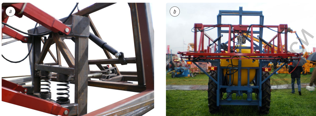
Рис. 3. Разработанные системы стабилизации штанги опрыскивателей «Мекосан-2500-18» (а) и ОШ-2300-18 (b)
