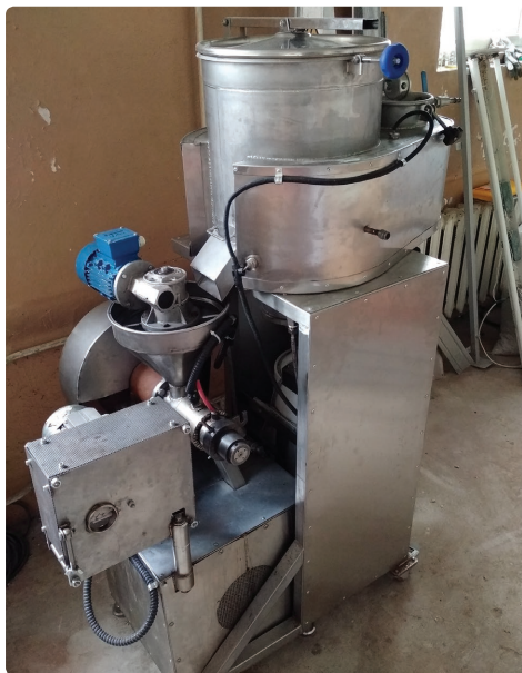
Рис. 3. Лабораторный кондиционер и экструдер. Разработка Научно-практического центра Национальной академии наук Беларуси по продовольствию, 2018 г.
