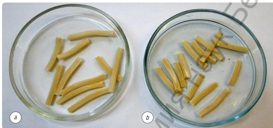
Рис. 5. Образцы полученных при испытаниях макаронных изделий ( a – с использованием специальных вставок; b – без вставок)
