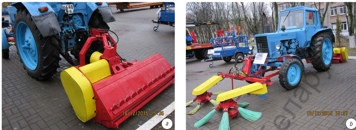
Рис. 7. Комплекс уборки веток плодовых деревьев КУВ-1,8: a – валкователь веток; b – измельчитель веток. Научно-прктический центр Национальной академии наук Беларуси по механизации сельского хозяйства, 2015 г.
