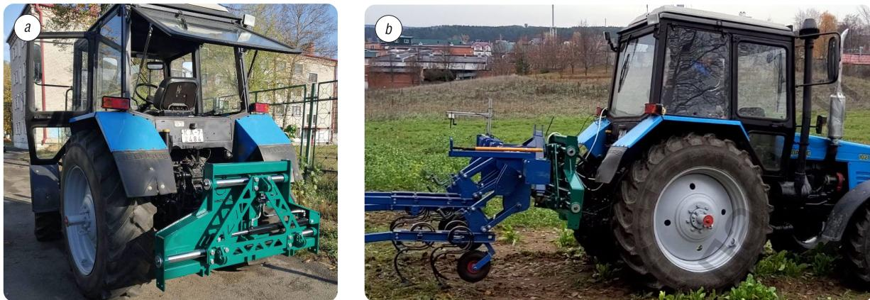
Рис. 1. Автоматическая управляемая навесная система: *a* – исполнительный механизм АУНС; *b* – исполнительный механизм АУНС в агрегате с пропашным культиватором. Научно-практический центр НАН Беларуси по механизации сельского хозяйства, 2020 г.
