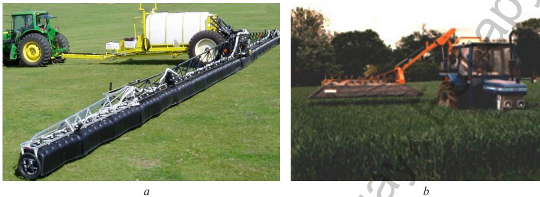
Рис. 4. Ветрозащитные устройства пассивного действия на штангах
