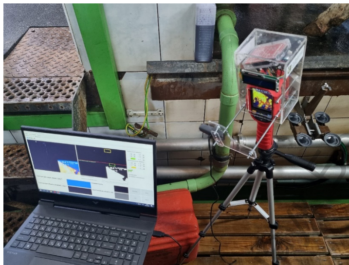
Рис. 1. Макетный образец устройства биометрической идентификации предмаститного состояния вымени коров дойного стада
